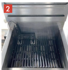
底網を油槽へ戻す
