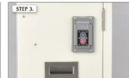
電源(AC100V)に接続し、電源ボタンを押す ※発電機を使用する場合、出力が2.2kVA以上必要
